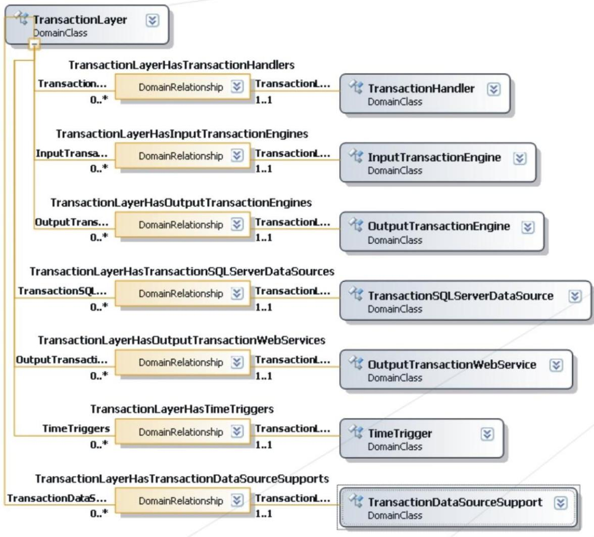
Figura 58 Diagrama de relaciones empotradas del elemento *TransactionLayer*.
