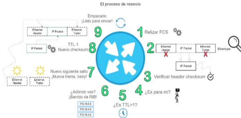
Figura 4-1 - Proceso reenvío de un router antiguo [45]
