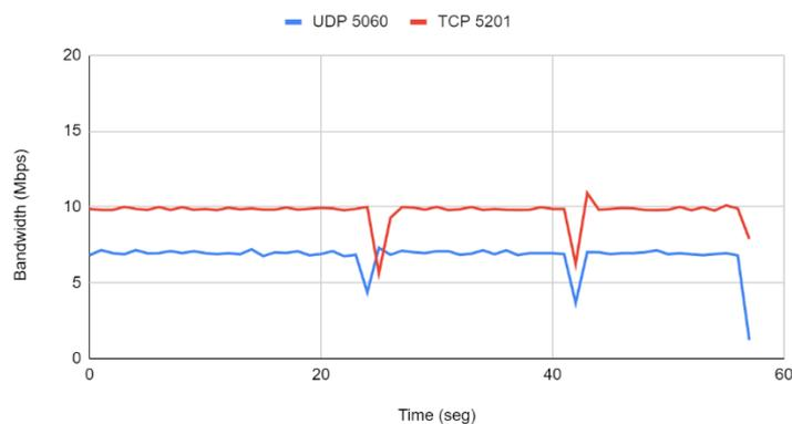
Figura 5.8. Ancho de banda utilizado por flujos UDP y TCP bajo políticas DiffServ
