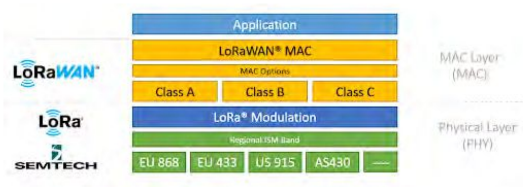
Fig. 4.1: LoRa® la capa física-LoRaWAN® capa de control de acceso al medio Fuente: (Lora-Alliance, 2020)
