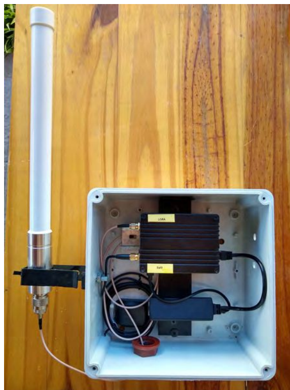
Fig. 6.8: Gateway en caja estanca para exterior fuente: autor
