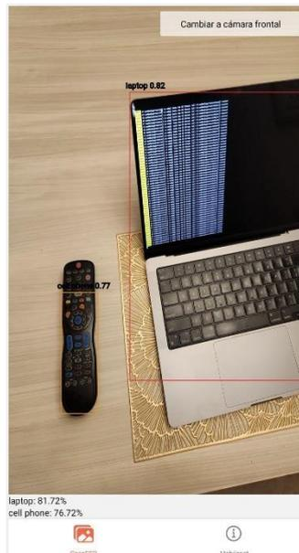
**Figura 4.8:** Aplicación prototípica implementada con *Tensorflow.js* y dos modelos pre-entrenados.
