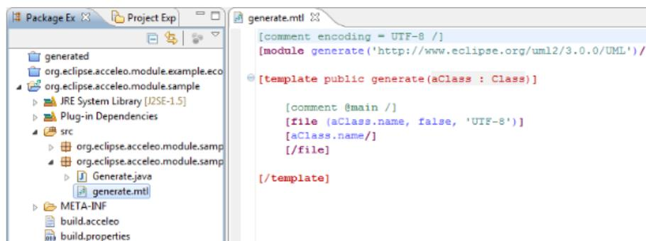
**Figura 4.4:** Vista de un módulo (*generate.mtl*) de Acceleo. Se aprecian las directivas de Acceleo, como la definición de un módulo, de un template, la generación de un archivo y el uso del metamodelo.
