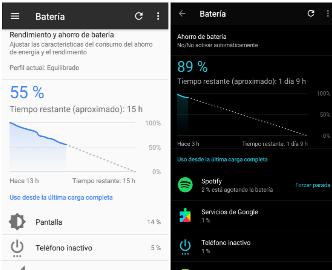
Figura 5. El inspector de batería de Android, que permite al usuario ver cuánto porcentaje de energía consumió cada aplicación o componente, y detener a las que más consuman.
