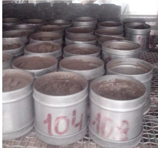
**Figura 3.6<sup>17</sup>:** Latas de aluminio usadas en la muestra de agua.
