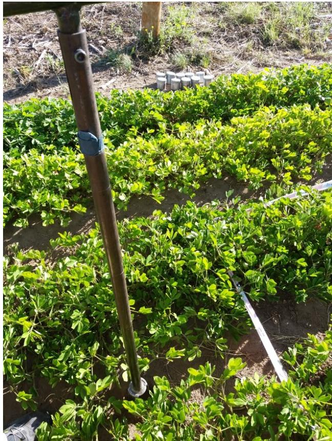
**Figura 3.5<sup>16</sup>:** Barreno usado para la muestra de agua.
