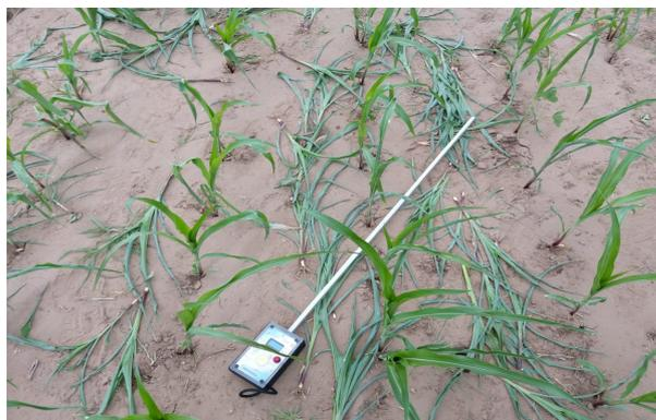
**Figura 3.8**<sup>19</sup>: Dispositivo Radiómetro.
