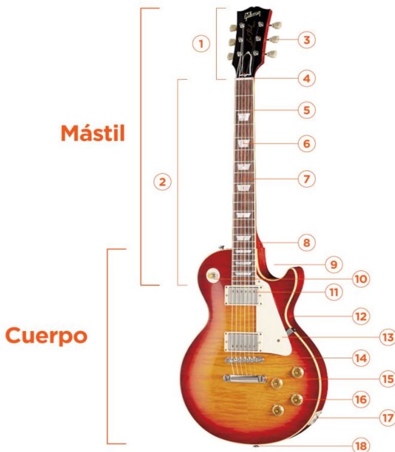
Figura 10 - Guitarra eléctrica - partes [47]
