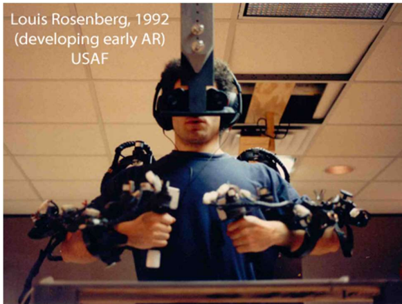
Figura 2.5: Virtual Fixture, dispositivo RA creado por Louis Rosenberg en 1992.
