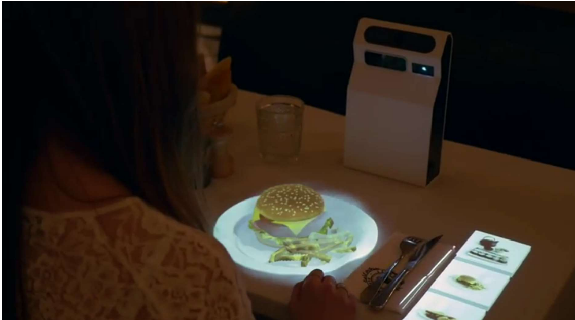
Figura 2.8: HoloLamp mostrando el plato de un cliente a la vez que puede seleccionar otros del menú.
