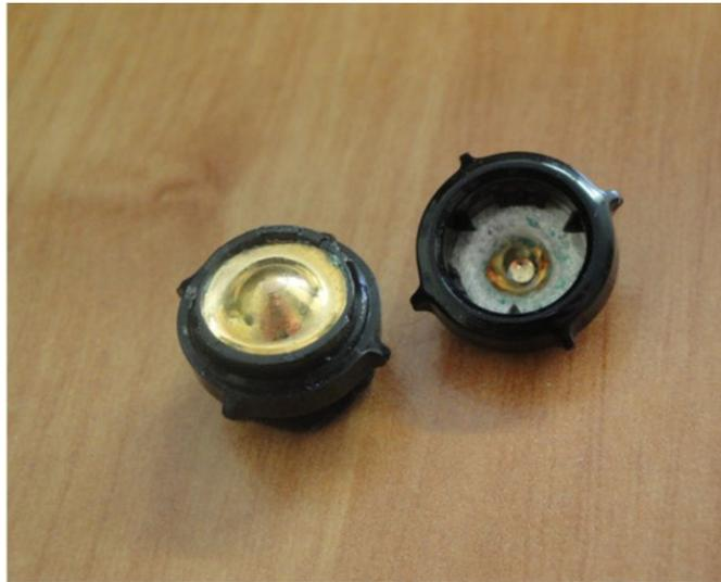
Figura 5.4: Óxido en sensores Emotiv Epoc. Duvinage (2013)
