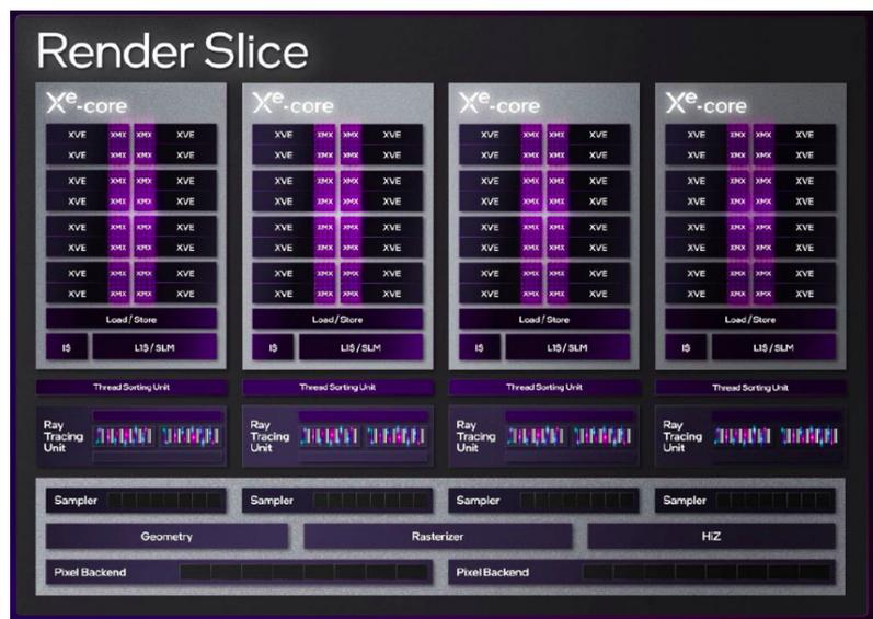
Figura 2.8: Diagrama representativo de la arquitectura dGPU de Intel (Xe Max) (extraído de [83]).
