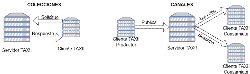
Figura 4ª Uso de los dos modelos de TAXII : Colecciones y Canales Traducido de la documentación de TAXII
