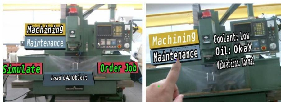
Figura 1.7. Interfaces RA para un Torno CNC (A.W.W. et. al., 2016)
