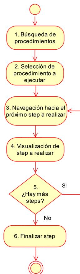
**Figura 4.4.** Flujo para explotar procedimientos en el prototipo de navegador de realidad aumentada semántico. [[Zoom](#)]
