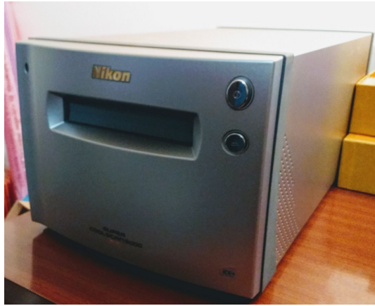
Figura 2.3: Escáner NIKON 9000ED modificado para la digitalización de placas espectrográficas.
