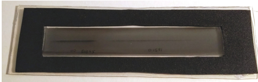
Figura 2.4: Placa espectrográfica con su correspondiente máscara.
