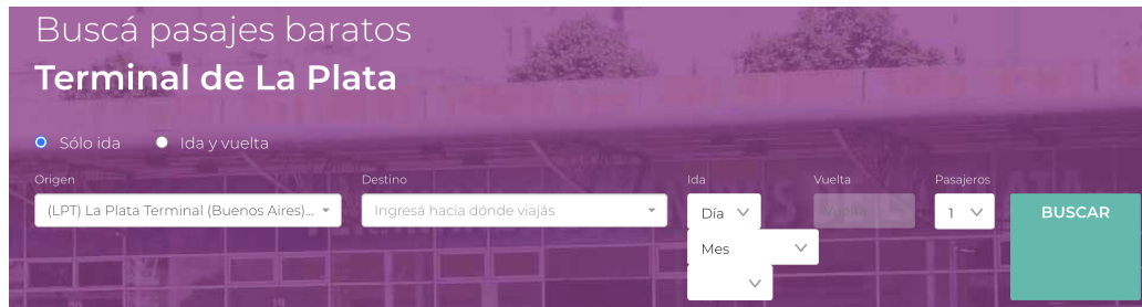
Figura 4.1: El refactoring Date Input into Selects en el campo “ida” produce una alteración no deseada en el layout de la página.
