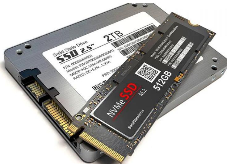
**Figura 8.** Dispositivos de almacenamiento de Estado Sólido (SSD).
