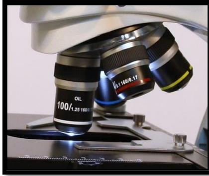
**Figura 2.10: Tambor de un microscopio. Imagen obtenida de <http://hnnbiol.blogspot.com.ar>**
