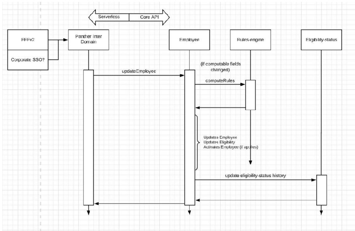
Luego de que se realice el procesamiento del archivo, la capa de Inter-Domain recibe la información necesaria para poder realizar la creación o actualización de un empleado. Nótese que se menciona una forma diferente de creación de empleados llamada Corporate SSO. Aunque no exista esa funcionalidad actualmente, la capa de Inter-Domain se desarrolló con la idea de múltiples puntos de entrada para la creación de empleados y que pudiera funcionar sin importar de donde provenga la información.
