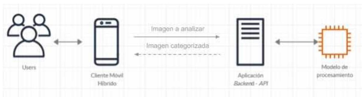
Figura 5.6 Arquitectura general del sistema planteado
