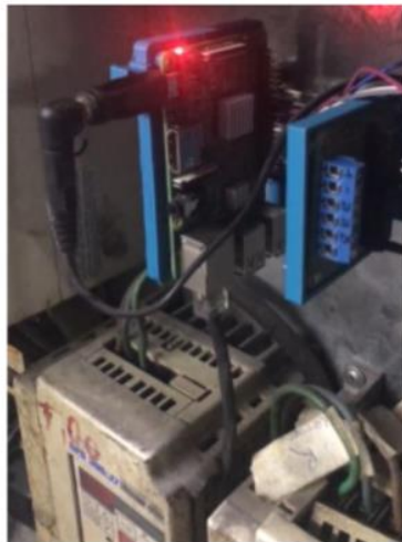
Fig 30 – Raspeberry instalada en una de las maquinas
