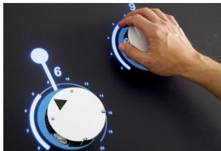
Figura 2.8: Ejemplo de aplicación con objetos activos donde un usuario mueve 2 objetos tangibles con un movimiento. La línea y el círculo muestran la ruta de movimiento y el destino. Extraído de (Pedersen y Hornbæk, 2011)
