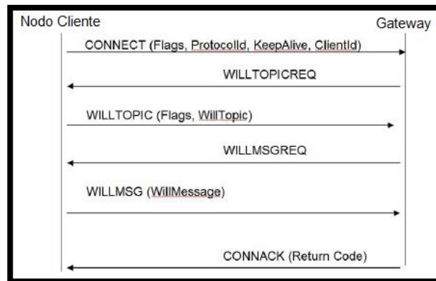
Figura 2.17. Mecanismo de conexión de un nodo cliente. Fuente: [19]
